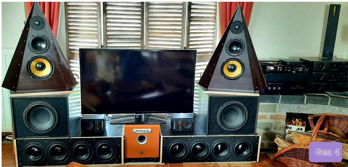
Le projet le plus ambitieux jusqu'ici utilise les atouts d'un nouveau DSP 8X8 Shenndare, entièrement câblé en symétrique. Ceci permet de dédier les entrées à des traitements différenciés et simultanés. Les sorties permettent d'utiliser quatre canaux stéréo entièrement programmables en fréquence, intensité et facteurs temporels.
