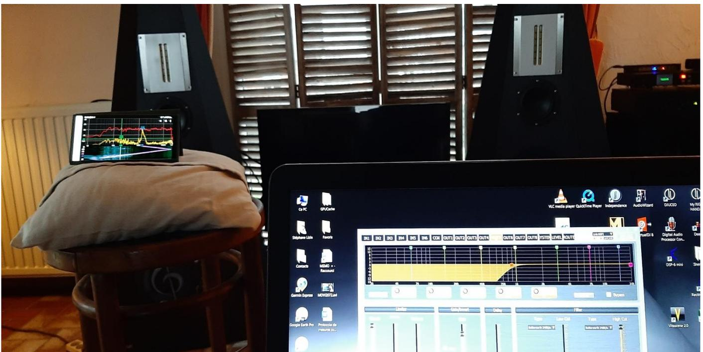
La partie médiane de l'ensemble, le canal 2, réservé au haut grave et traduite par le Haut-Parleur Faital Pro 350 Monitor monté en Baffle Clos très amorti autour de 28 litres de volume affiche lors de ce test une belle plage d'énergie en Bruit Brun, selon EQ : voici avant lecture =
