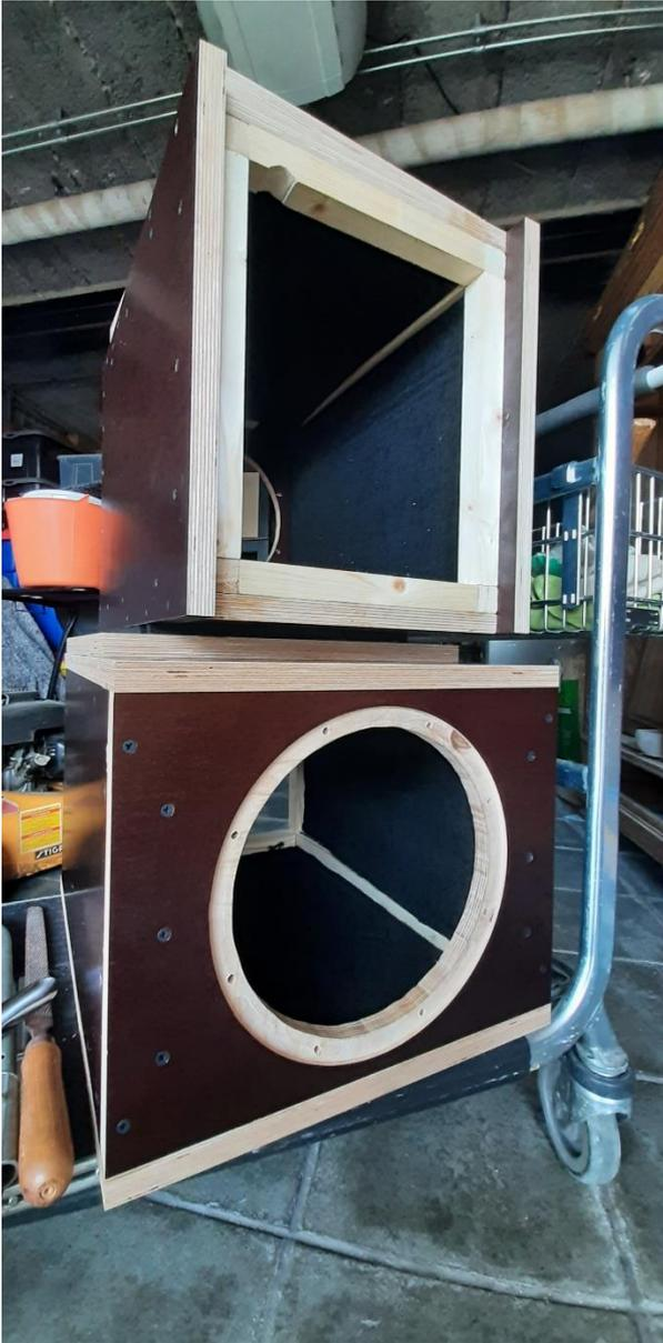
La pose d'un matériau adhésif lourd (Butyle) garni d'une feuille d'aluminium limite encore les résonances du montage et permet le garnissage intérieur d'un feutre adhésif pour contribuer à l'amortissement du signal acoustique.
