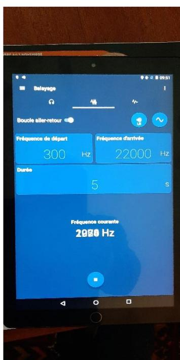
L'application « Générateur de Fréquences » fournit les signaux de mesure, alternativement en Sinus et en Bruit.
